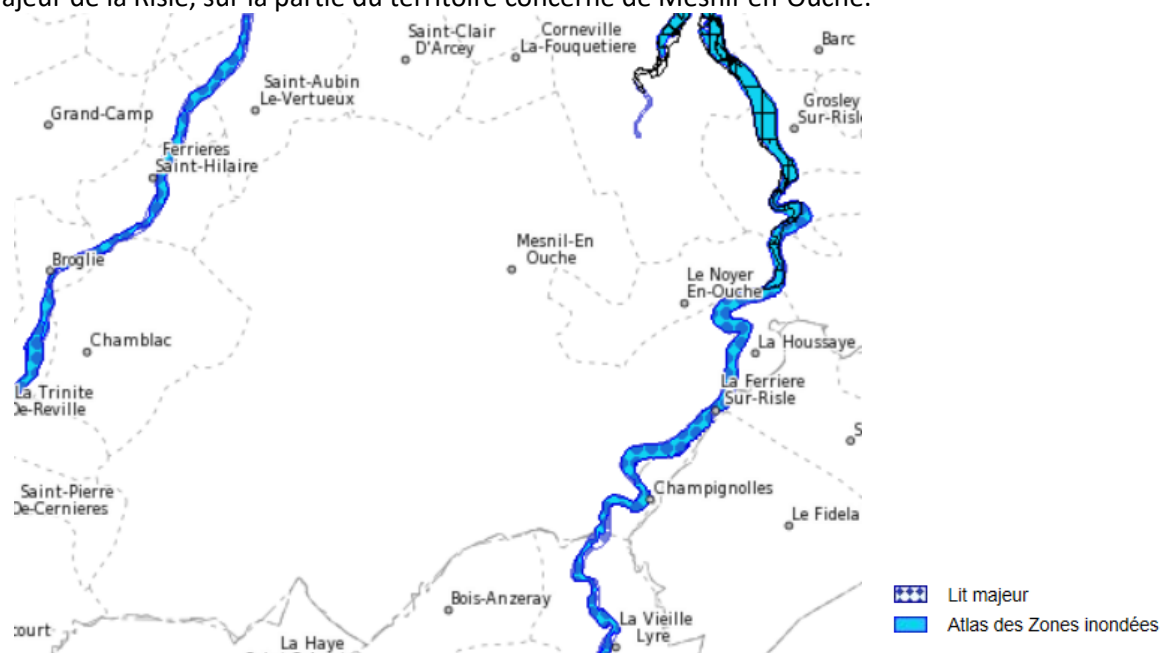
Carte 55. Les secteurs à risques d'inondation sur la commune de Mesnil-en-Ouche – Localisation du lit majeur. Source : Atlas des Zones Inondées – DDTM de l'Eure (consultation de géo-ide en date de mars 2018)
